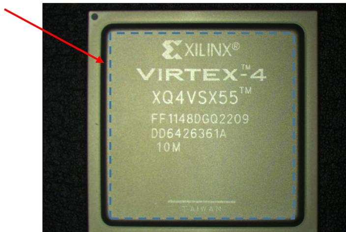
图 8 器件平面图（疑似打磨区域）
