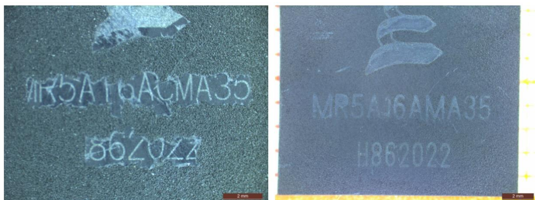
附图4 局部涂覆层脱落
